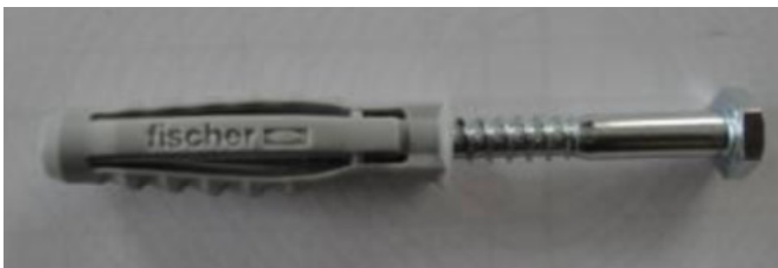
Figura 11 - Bucha 10 - \phi 6-8 , utilizada para fixação da mão-francesa
