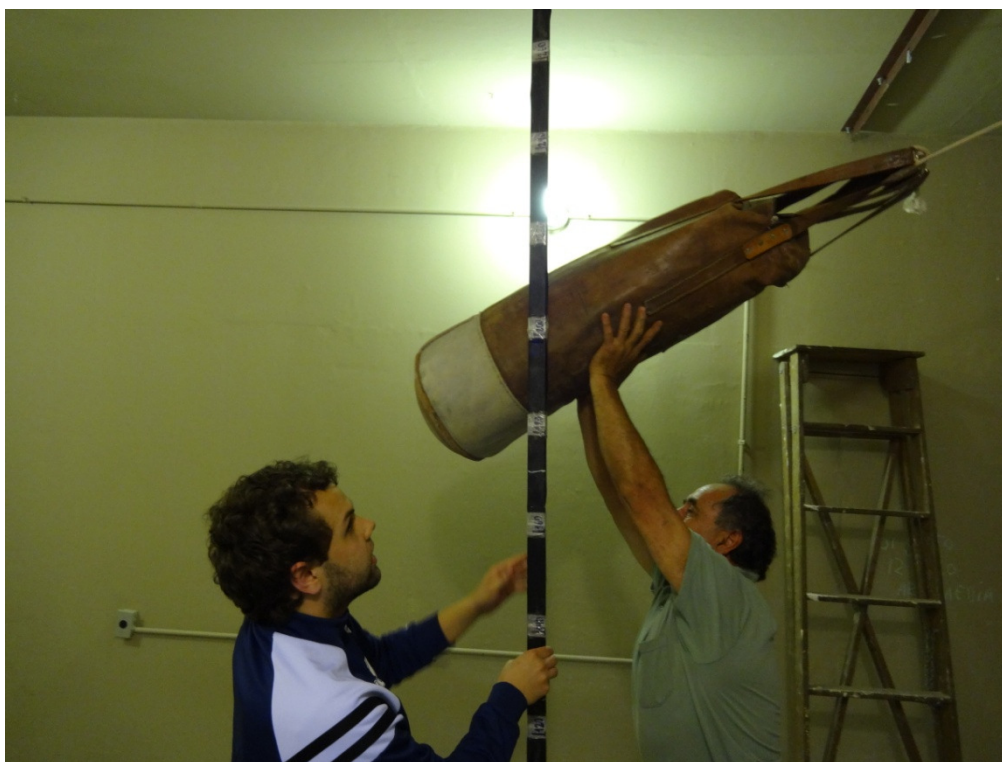
Figura 15 – Realização de ensaio de impacto de corpo mole
