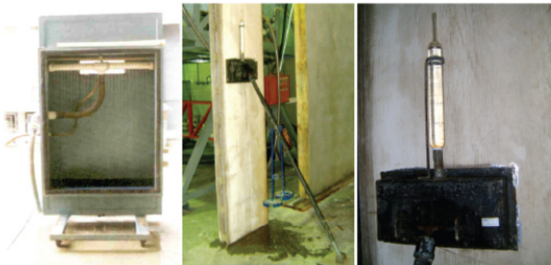
Figura 5 - Câmara para ensaio de estanqueidade (esq.) e câmara para ensaio de paredes de áreas molháveis
