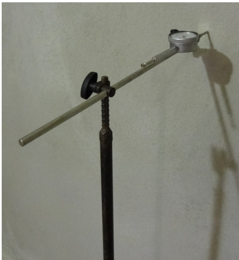
Figura 10 - Defletômetro utilizado para medir deslocamentos horizontais da parede
