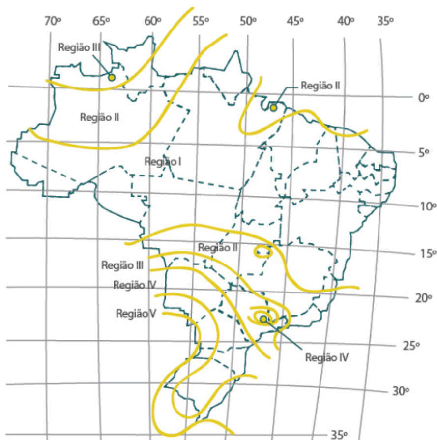
Figura 33 - Regiões brasileiras consideradas para ensaio de estanqueidade
