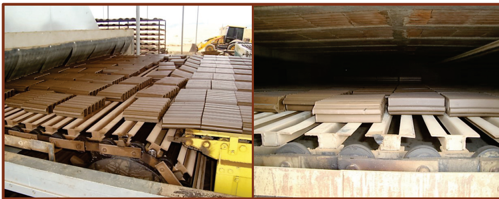
Figura 8 - Funcionamento de um secador tipo talisca
