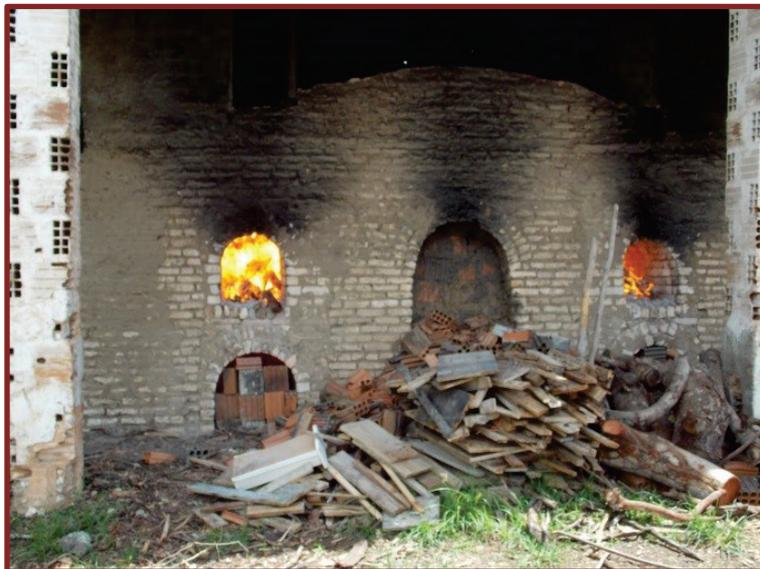
*Figura 8 - Resíduos de construção utilizado como combustível cerâmica*
