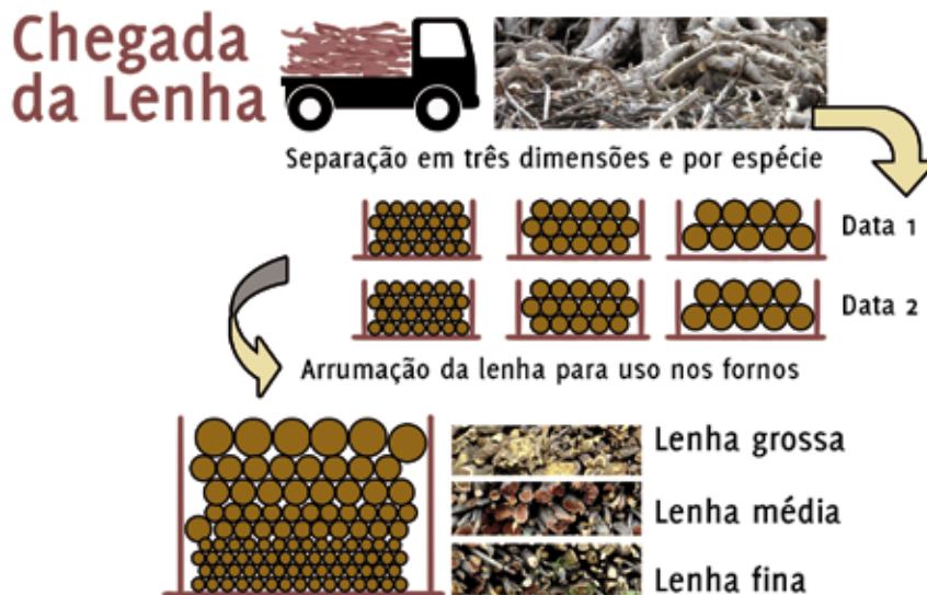
Figura 18. Modelo de Pátio para manuseio e secagem de lenha por espécie e por grossura
