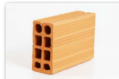
Vedação 9x19x29 Peso: 3,8 kg por peça Peças por carga Toco: 3.200 unidades Peças por carga Truck: 4.000 unidades Peças por m²: 16,7
