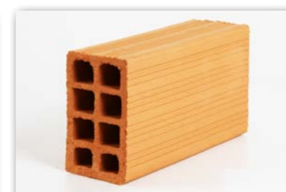
Vedação 11,5x19x39 Peso: 6,7 kg por peça Peças por carga Toco: 1.820 unidades Peças por carga Truck: 2.300 unidades Peças por m²: 12,5
