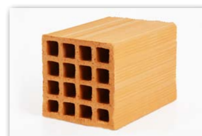
Vedação 19x19x29 Peso: 8 kg por peça Peças por carga Toco: 1.500 unidades Peças por carga Truck: 2.000 unidades Peças por m²: 16,7
