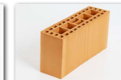
Estrutural 11,5x19x39 Peso: 6,8 kg por peça Peças por carga Toco: 1.700 unidades Peças por carga Truck: 2.200 unidades Peças por m²: 12,5
