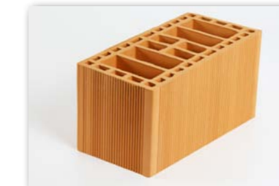
Estrutural 19x19x39 Peso: 8,7 kg por peça Peças por carga Toco: 1.000 unidades Peças por carga Truck: 1.300 unidades Peças por m²: 12,5
