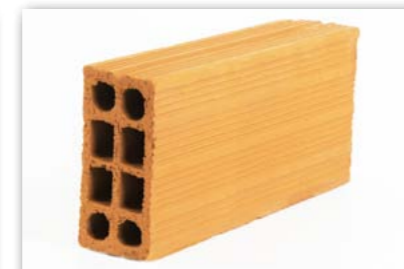
Vedação 9x19x39 Peso: 5,6 kg por peça Peças por carga Toco: 2.100 unidades Peças por carga Truck: 2.800 unidades Peças por m²: 12,5
