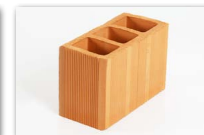
Vedação 14x19x29 (com 3 furos) Peso: 5,2 kg por peça Peças por carga Toco: 2.100 unidades Peças por carga Truck: 2.800 unidades Peças por m²: 16,7
