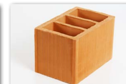
Vedação 19x19x29 (com 3 furos) Peso: 8 kg por peça Peças por carga Toco: 1.500 unidades Peças por carga Truck: 2.000 unidades Peças por m²: 16,7
