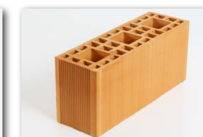
Estrutural 14x19x44 Peso: 9,1 kg por peça Peças por carga Toco: 1.300 unidades Peças por carga Truck: 1.700 unidades Peças por m²: 11,1
