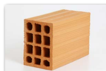
Vedação 14x19x29 Peso: 5,2 kg por peça Peças por carga Toco: 2.100 unidades Peças por carga Truck: 2.800 unidades Peças por m²: 16,7
