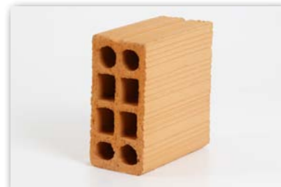
Vedação 9x19x19 Peso: 2,4 kg por peça Peças por carga Toco: 4.200 unidades Peças por carga Truck: 5.600 unidades
