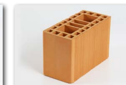
Estrutural 14x19x29 Peso: 5,8 kg por peça Peças por carga Toco: 2.100 unidades Peças por carga Truck: 2.800 unidades Peças por m²: 16,7
