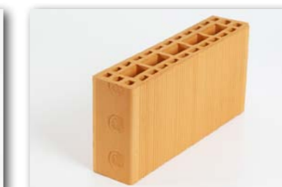
Estrutural 9x19x39 Peso: 6,2 kg por peça Peças por carga Toco: 2.100 unidades Peças por carga Truck: 2.700 unidades Peças por m²: 12,5
