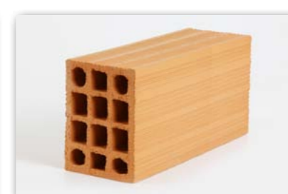
Vedação 14x19x39 Peso: 7 kg por peça Peças por carga Toco: 1.540 unidades Peças por carga Truck: 2.000 unidades Peças por m²: 12,5
