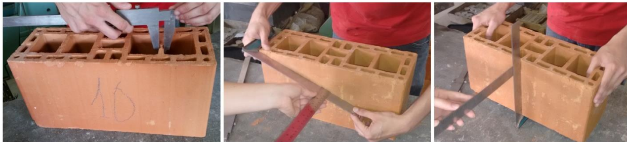
Figura 4.2: Análise dimensional, desvio em relação ao esquadro e planeza das faces dos blocos cerâmicos
