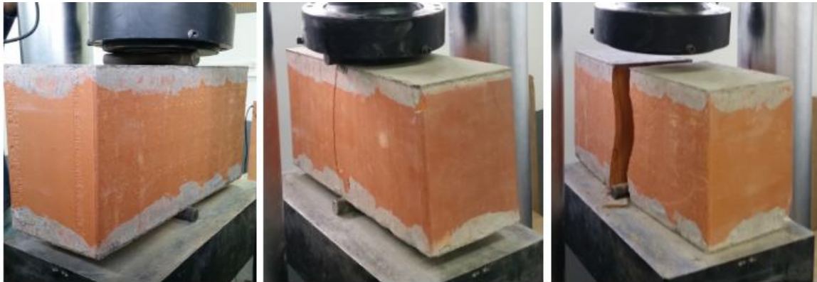
Figura 4.5: Ensaio de determinação indireta da resistência à tração dos blocos
