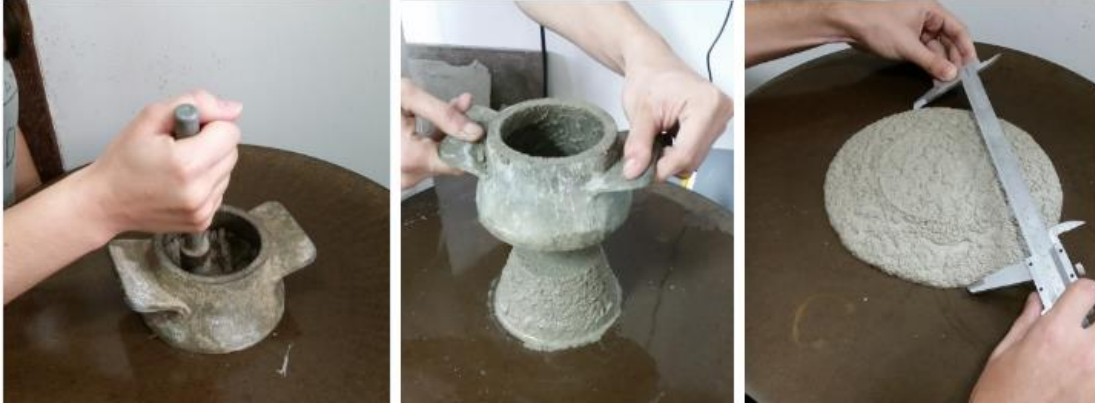
Figura 4.9: Ensaio de determinação do índice de consistência da argamassa
