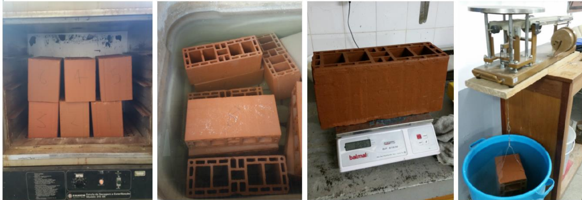
Figura 4.3: Determinação de massa seca, úmida e aparente dos blocos cerâmicos
