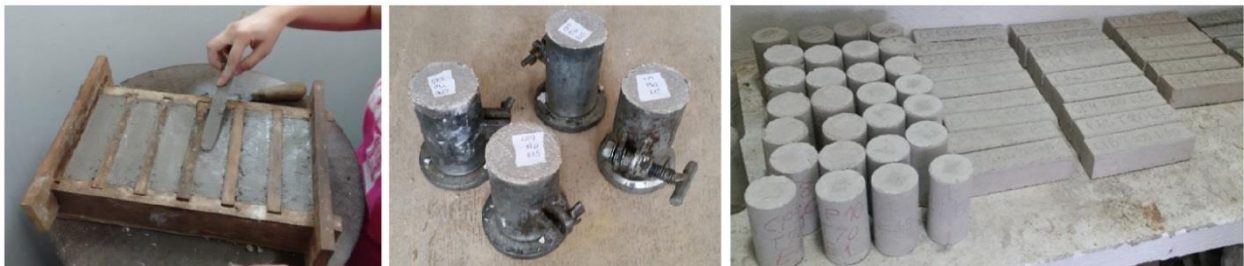
Figura 4.10: Moldagem e cura de corpos de prova prismáticos e cilíndricos de argamassa
