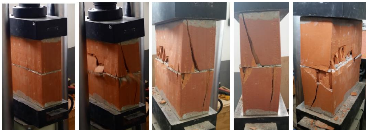
Figura 5.35: Mecanismo de ruptura do prisma P4 do lote T90 E0,5
