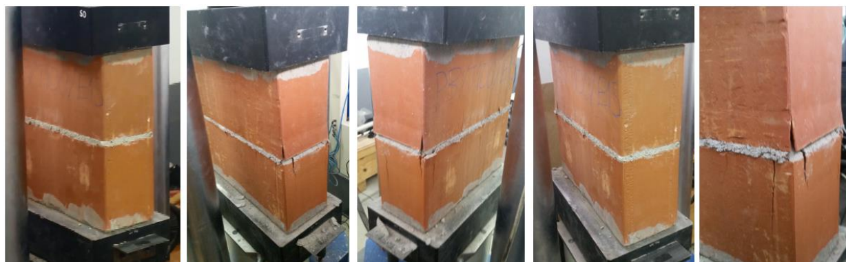
Figura 5.36: Mecanismo de ruptura do prisma P3 do lote T90 E1,5
