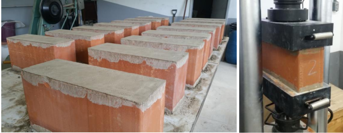
Figura 4.4: Caapeamento dos blocos cerâmicos e ensaio de resistência à compressão
