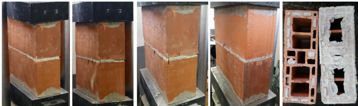
Figura 5.34: Mecanismo de ruptura do prisma P6 do lote T30 E1,5
