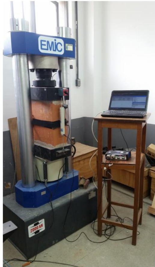
Figura 4.14: Instrumentação de prismas proposta pela ABNT NBR 15812-2:2010 e realizada no presente trabalho.
